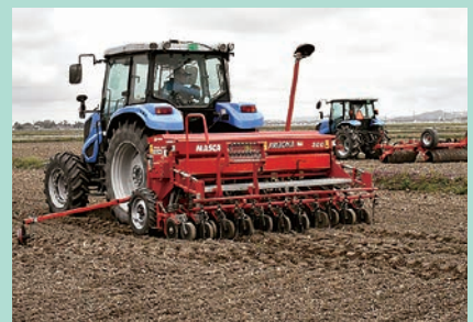
ドリルシーダーでの播種作業(手前)とケンブリッジローラーでの鎮圧作業(奥)を行う
